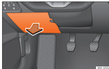
Joonis 55 Armatuurlaua juhipoelses otsas: kaitsmekarbi kate
