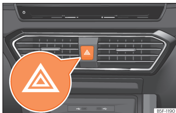
Joonis 103 Armatuurlaual: ohutulede lüliti
