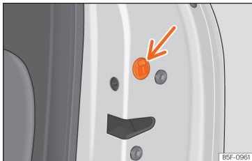
Joonis 90 Avariilukk ukse käsitsi lukustamiseks
