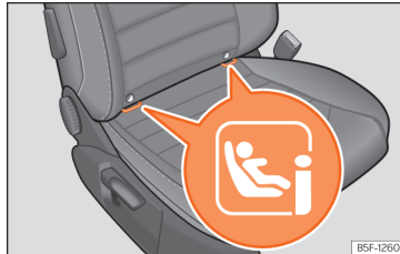
Joonis 33 Kaassõitja esiiste: ISOFIX-/i-Size-kinnitusaasad
