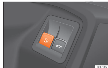
Joonis 217 Juhiuksel: kütusepaagi luugi avamislüliti
