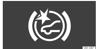
Joonis 176 Näidikuploki ekraanil: kokkupõrke hoiatuse näit
