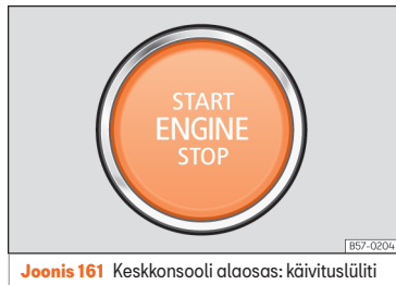
Joonis 161 Keskkonsooli alaosas: käivituslülit
