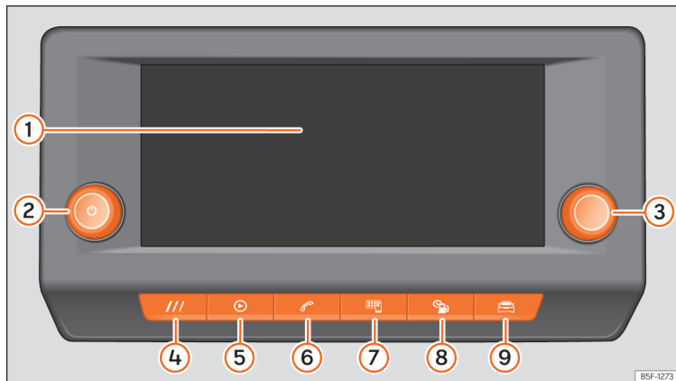
Joonis 153 Ülevaade: juhtpaneel koos 8,25-tollise ekraaniga
