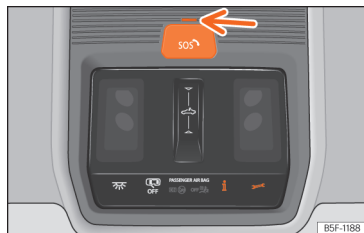
Joonis 37 Laekonsoolis: kõneteenuste lülitid
