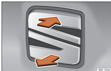
Joonis 92 Tagaluuk: avamine väljastpoolt
