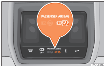
Joonis 21 Laekonsoolis: esiistmel istuva kaassõitja välja lülitatud esiturvapadja hoiatustuli
