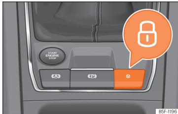
Joonis 86 Keskkonsoolis: kesklukustustüliti
