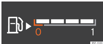
Joonis 68 Digitaalne näidikuplokk: sõltuvalt vaatest võib kütusemõõdik asuda eri kohtades
