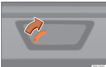
Joonis 97 Pagasiruumi detail: avariavaja (Leon Sportstourer)
