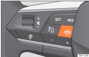
Joonis 73 Multifunktsionaalse rooli vasak pool: juhiabisüsteemide lüliti (sõltuvalt mudeliversioonist)
