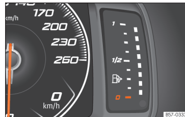
Joonis 66 Digitaalne näidikuplokk: kütusemõidik
