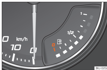
Joonis 65 Analoognäidikuplokk: kütusemõidik
