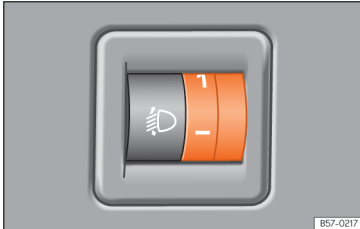
Joonis 96 Rooli kõrval: esitulede valgustuskauguse regulaator
