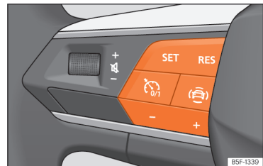
Joonis 145 Multifunktsionaalsel roolil: kiirushoidiku lülitid
