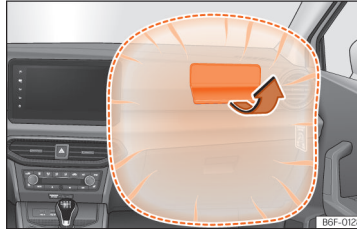
Joonis 15 Esiistmel istuva kaassõitja esiturvapadi armatuurlaual
