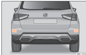
Joonis 142 Auto tagantvaade: radarandurite asukohad
