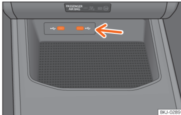
Joonis 128 Keskkonsooli: USB-pesa
