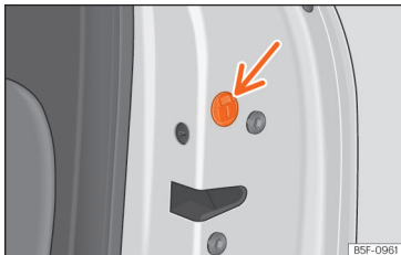
Joonis 87 Avariilukk ukse käsitsi lukustamiseks
