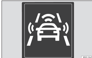
Joonis 147 Näidikuploki ekraanil: kokkupõrke hoiatuse näit
