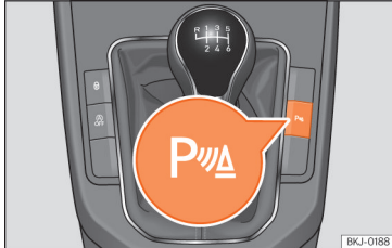
Joonis 170 Keskkonsoolis: parkimisabisüsteemi lüliti (sõltuvalt versioonist).
