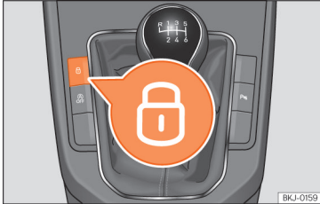
Joonis 82 Keskkonsoolis: kesklukustuslülitid
