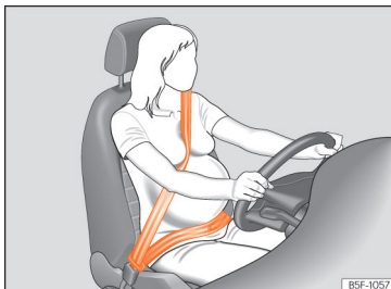
Joonis 13 Turvavöö õige asend raseduse ajal
