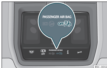
Joonis 20 Laekonsoolis: esiistmel istuva kaassõitja välja lülitatud esiturvatagja hoiatustuli
