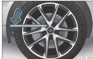
Joonis 41 Ratta vahetamine: rattapoldide lahtikeeramine
