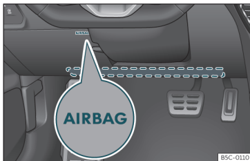
Joonis 21 Juhikohal: põlveturvapadja asukoht
