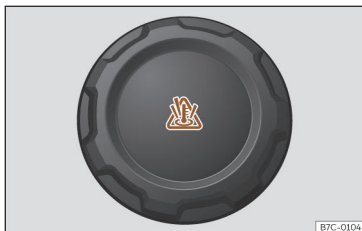
Joonis 158 Kapotialuses tehnooruumis: jahutusvedeliku paisupaagi kork
