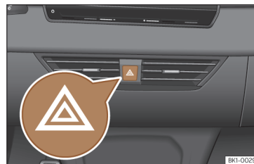
Joonis 40 Armatuurlaual: ohutulede lüliti
