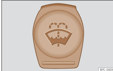
Joonis 160 Kapotialuses tehnoruumis: klaasipesuvedeliku paagi kork
