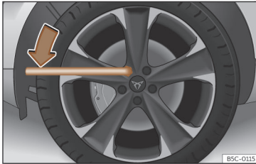
Joonis 167 Ratta vahetamine: rattapoltide lahtikeeramine
